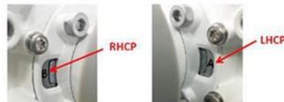
Рисунок 1 положение поляризации трансивера
